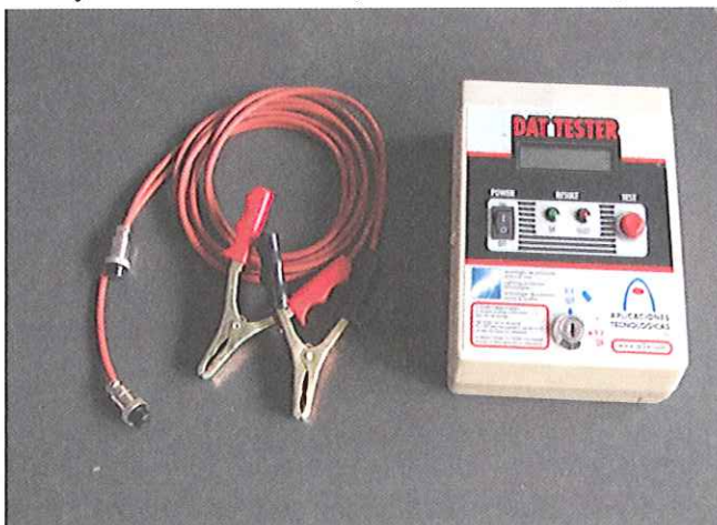
Obr.11.6.3 Testovací prístroj aktívnej časti bleskozvodu
